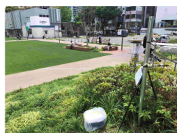
写真7 カメラ・日射計設置状況
