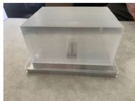
図10 アクリル板を使用したセンサ
