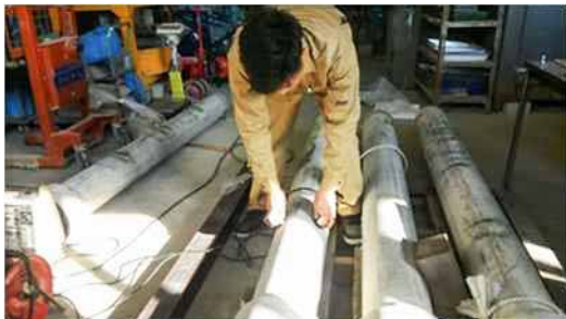
写真 1 使用したヒューム管と超音波伝搬速度の測定状況
