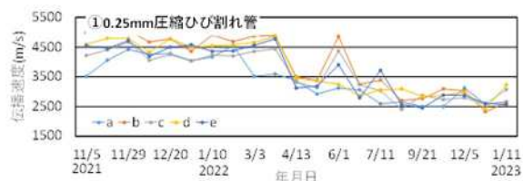
図6 超音波伝搬速度の低下状況の一例 (2m電柱、0.25mm 圧縮ひび割れ導入管)
