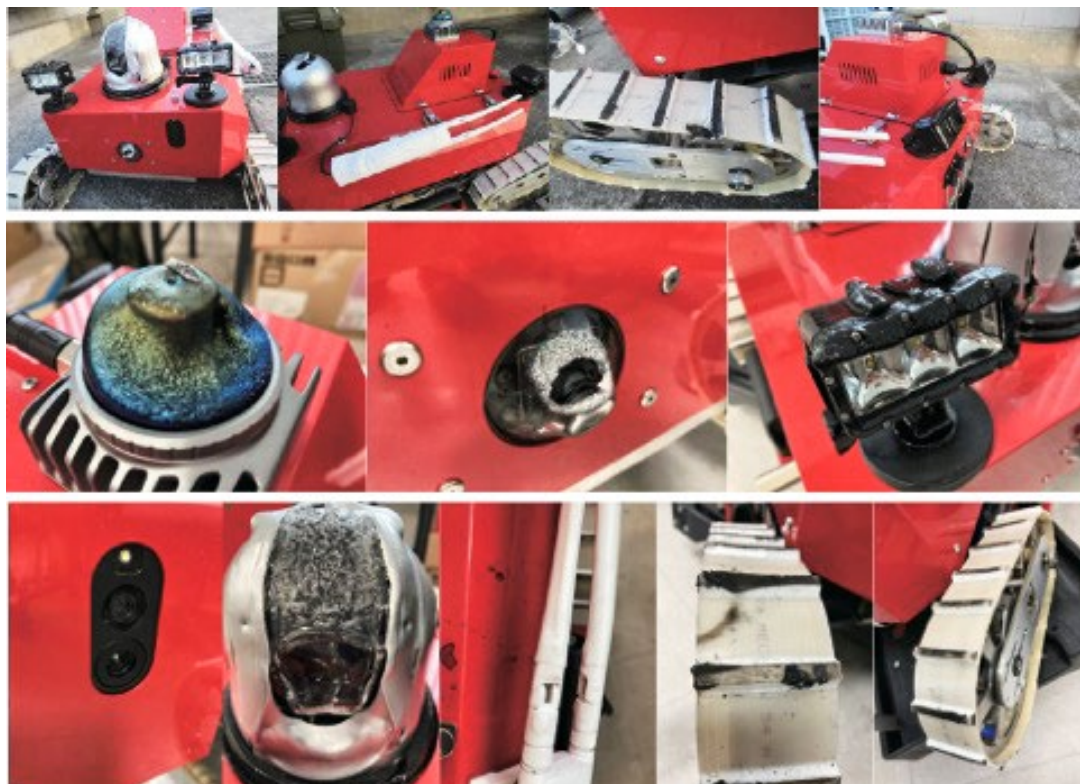
図4 断熱検証実験後のロボット損傷状況
