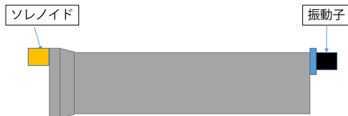
図 2 ソレノイドを用いた劣化診断実験装置配置図
