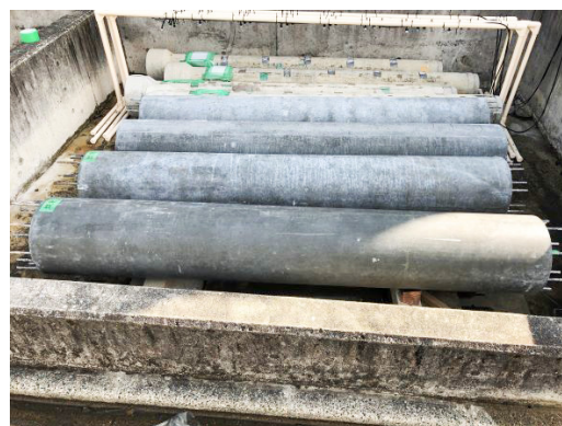
図1a 作成した小型電柱供試体（PC構造） （手前側4本）
