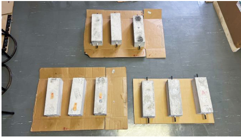
図 1b 作成した角柱供試体 (RC 構造)
