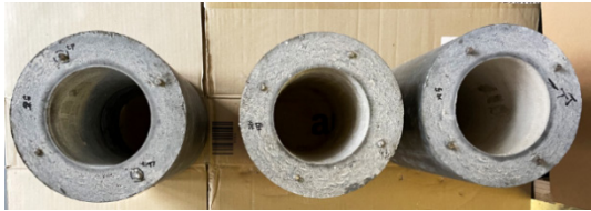
図 1c 作成した円柱供試体 (RC 構造)
