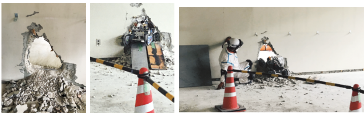
図4 左 ブリーチング開口部、中央 ロボット進入時の様子、右 ロボット帰還時の様子
