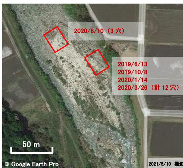
図3. 上村川澄ヶ瀬における河床の掘削の調査範囲と調査日およびその時の穴の数
