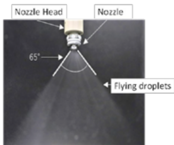
図1 高圧ジェットによる純水噴霧の様子
