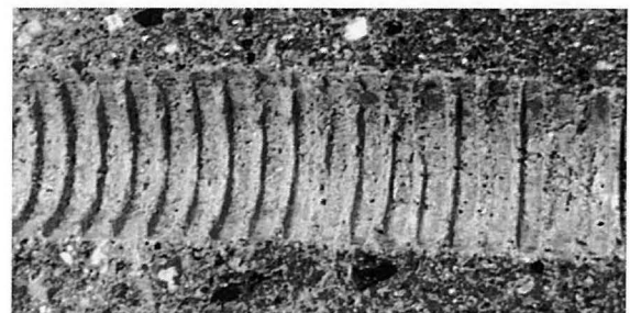
公称径14.1mmのCTの表面凹凸の痕跡
