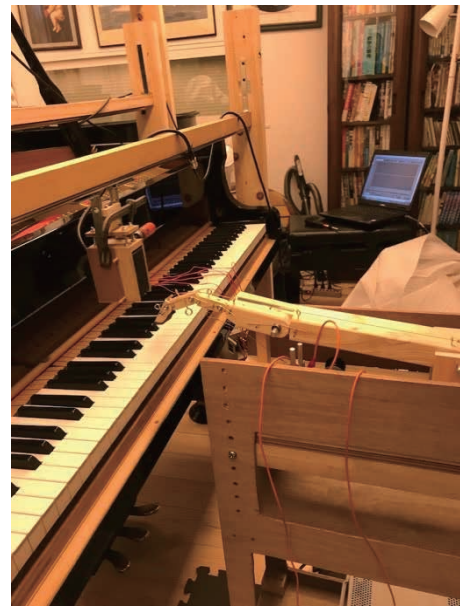
図 2: 鍵盤上部のレーザ変位計と人型打鍵装置（鍵盤右側）。鍵盤上部の赤いワイヤは歪みゲージのケーブルである。
