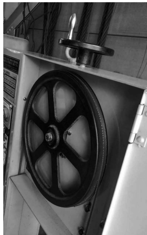
[写真-8] 鋸刃プーリー部
