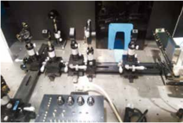
図2 Al/Ni 多層膜反応誘起のためのレーザーシステム
