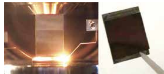
図 1 Al/Ni 多層膜を用いた瞬間ハンダ接合の様子
