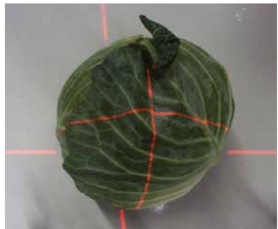
図3. 光切断法センサによる計測画像
