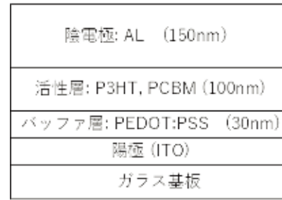
図 2 試作した有機薄膜太陽電池の構造
