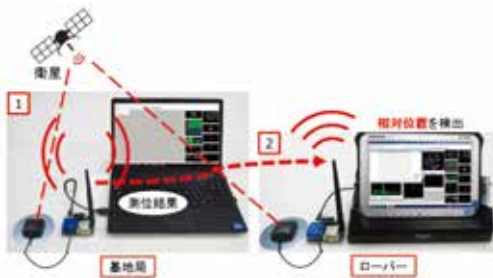
図-2 高精度 GPS u-blox C94-M8P-4
