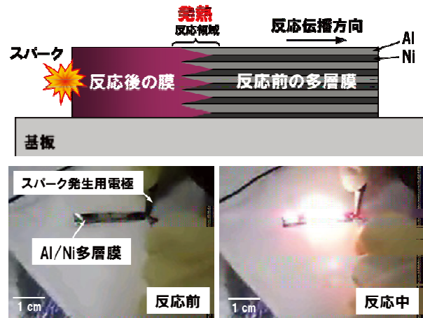
図 1 Al/Ni 多層膜の発熱反応の様子
