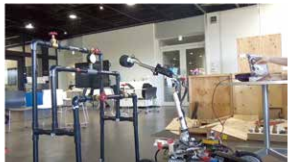
図2 マスタースレーブ操作システムを使った圧力ゲージの目盛り読み取り操作風景
