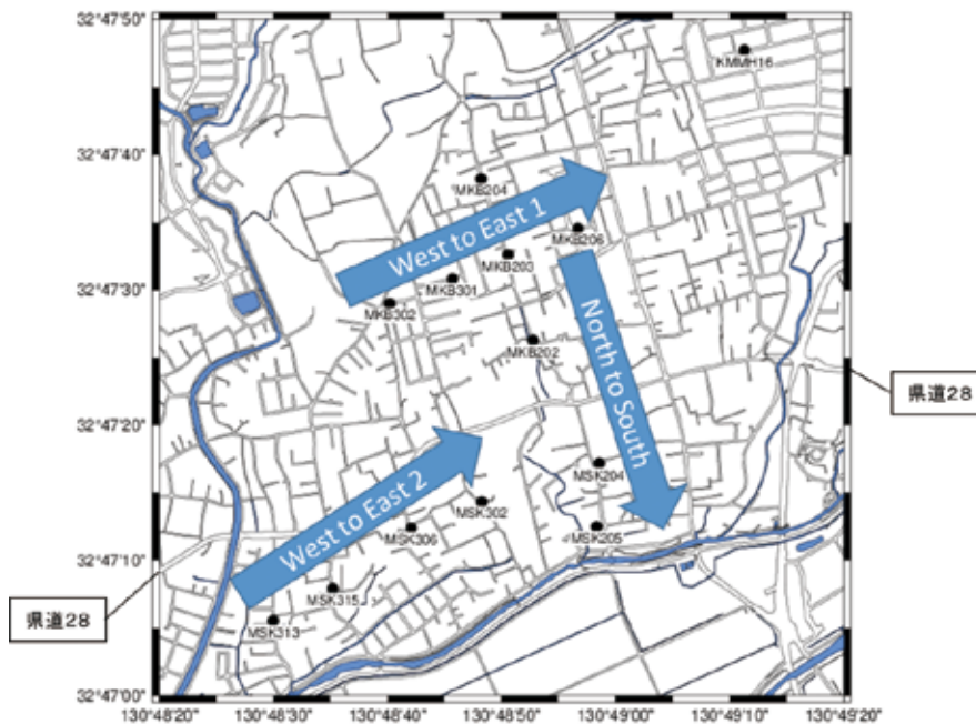
図2 微動観測点（黒丸）の分布。3つの測線（West to East 1, North to South, West to East 2）微動観測点を配置する。県道28号の南側と北側の観測点を区別するため、北側の観測点の名称は「B」を数字の前につけた。
