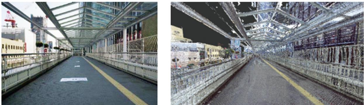
図9 現地写真と点群データでの再現結果の比較（左：現地写真、右：点群データ）
