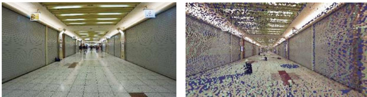
図6 現地写真と点群データでの再現結果の比較（左：現地写真、右：点群データ）
