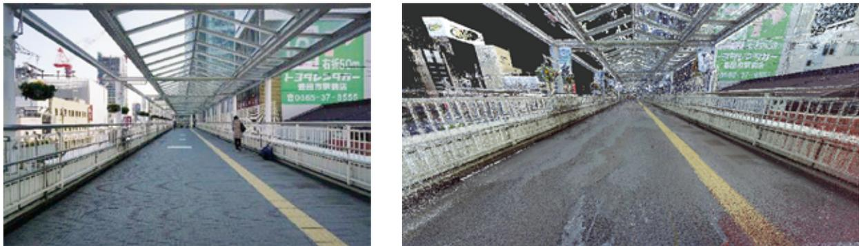
図8 現地写真と点群データでの再現結果の比較（左：現地写真、右：点群データ）
