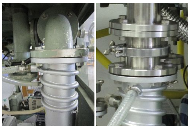
(1) 改良前 (JIS 規格) (2) 改良後 (ISO 規格)
