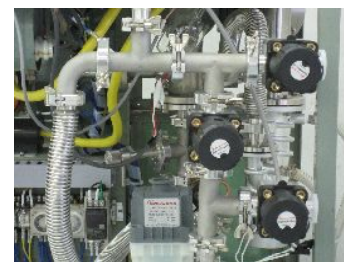
図 10 拡張性ある配管ジョイント
