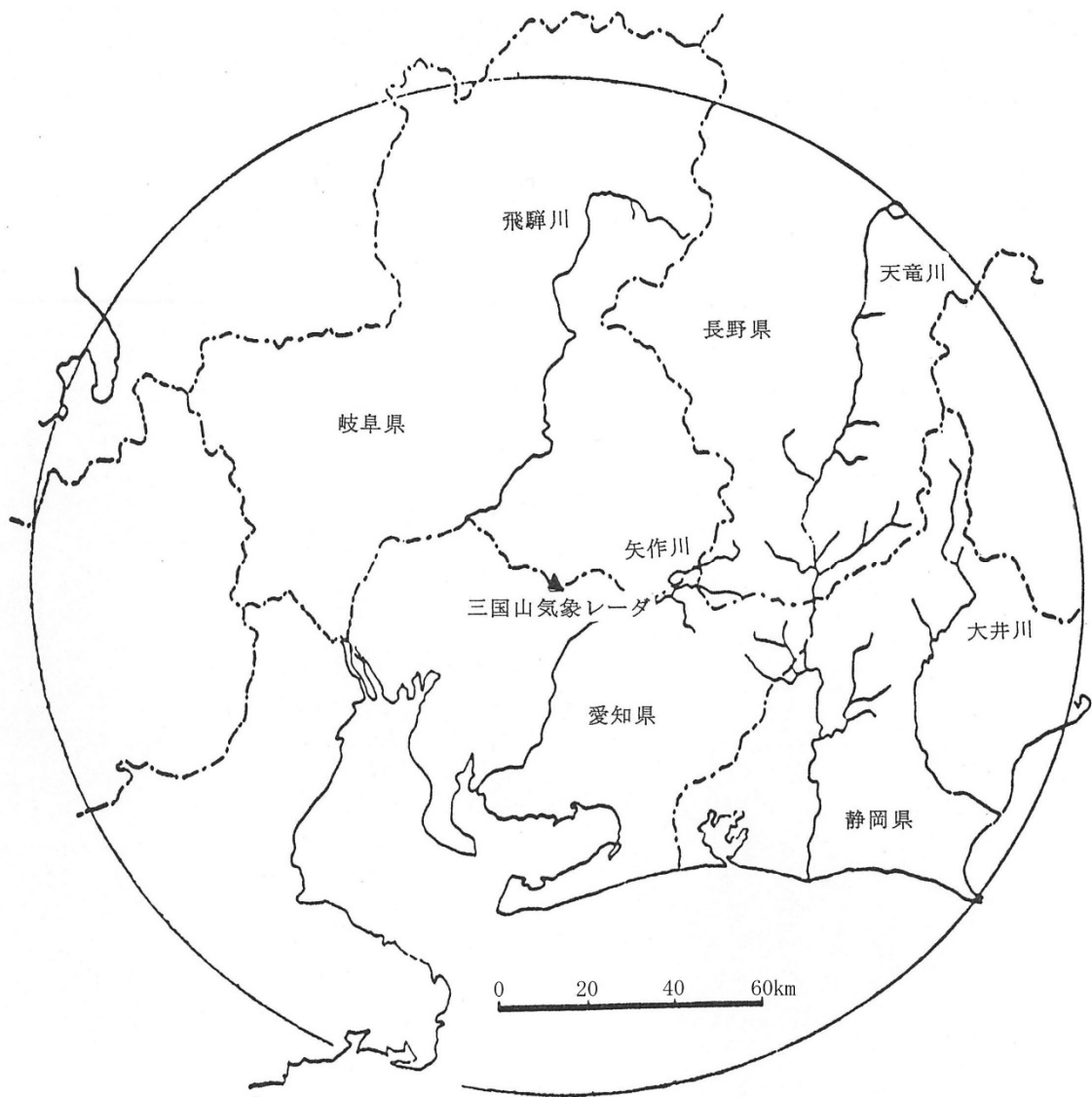
図 2.2 三国山気象レーダの定量観測範囲 (出典：東芝：三国山気象レーダ観測装置使用説明書)
