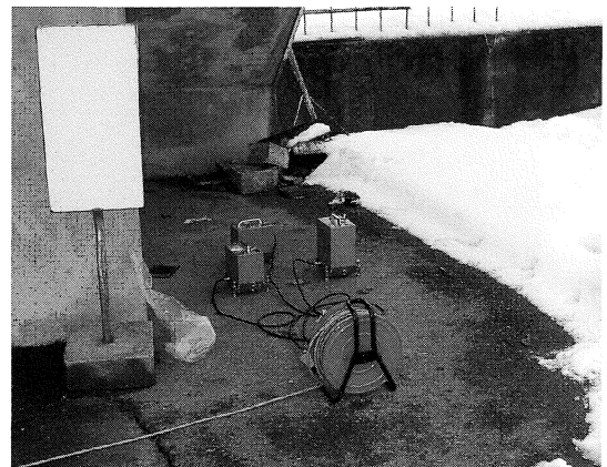
写真1. 地点1: 川口町役場における3成分微動観測の写真
