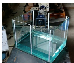
写真-3 寸法比1:1.3の貯槽(No.3)
