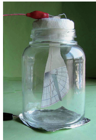
図 1 手作りの箔検電器。斜め後方から見ているので、箔の開き角と目盛りとは合っていない。
