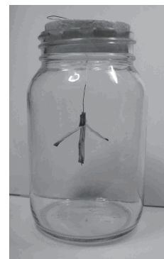
補図 1 丸型のコーヒー瓶に作った錫箔 (厚さ 1.3 \mu\text{m} ) 検電器
