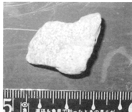
写真1 原コンクリートから取り出した骨材(改善前)
